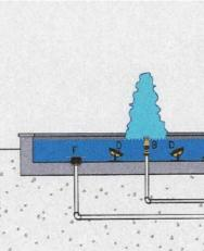
A. Pompa centrifuga B. Ugello C. Bacino d'acqua D. Foro subocqueo E. Scatola di derivazione stagna F. Presa di aspirazione Pannello elettrico di controllo
